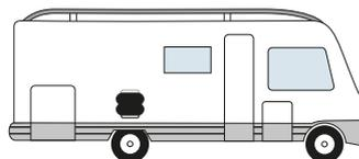
■ Die Zusatz-Luftfedern heben das Heck an und sorgen für ausreichend Federweg und flexibler Anpassung der Federeigenschaft.
