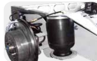
■ Montagebild: Zusatz-Luftfeder für Euro-Chassis, Typ X250
