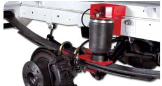
Abbildung: Mercedes Sprinter 208-316 mit 2-Balg-Anlage und Kegelbälgen („Tapered Sleeves“). Die großflächigen Montagehalter (rot) leiten die Kräfte besonders schonend in den Rahmen ein. Ausgefüllte Schraubverbindungen sorgen für schnelle und sichere Montage.
