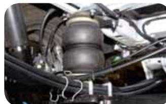
■ 6"-Doppelfaltenbalg im eingebauten Zustand
