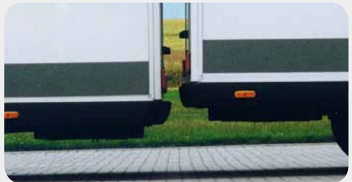
Die Zusatz-Luftfeder hebt das Fahrzeugheck deutlich an und sorgt damit für bessere Fahrsicherheit und erhöhten Komfort
