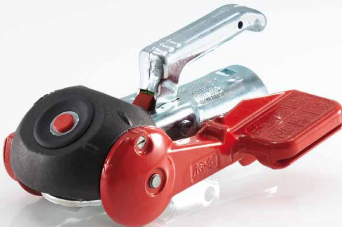
Durch Betätigen des Stabilisierungsgriffs werden zwei Reibbeläge von links und rechts an die Anhängerkugel des Pkws gepresst. Pendel- oder Nickbewegungen werden wirksam unterdrückt. Zudem lässt sich das Gespann in einer Notsituation schneller beruhigen.
