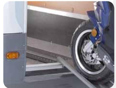
■ Auffahrschiene sicher befestigt
