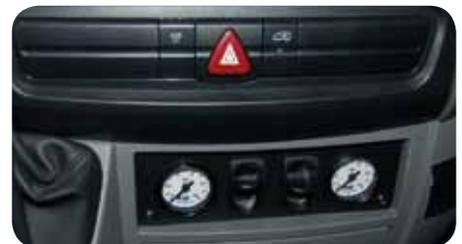
■ Fahrzeugspezifisches Bedienteil im Fahrerhaus
