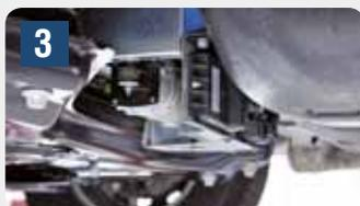
3 ■ Wartungsfreie Luftversorgungsanlage mit integrierter Steuerelektronik
