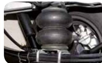
■ 8"-Doppelfaltenbalg im eingebauten Zustand
