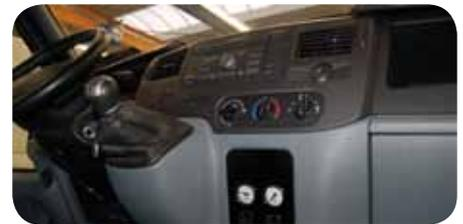
■ Fahrzeugspezifisches Bedienteil im Führerhaus
