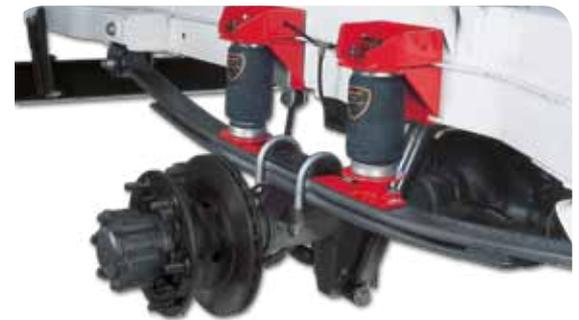
Mercedes Sprinter 408-416 mit 4-Balg-Anlage und Rollbälgen. Die beiden Montagehalter pro Seite leiten die Kräfte großflächig von der Achse zum Rahmen. Auch bei dieser Anlage werden sämtliche Anbauteile mit wenigen Schrauben befestigt.
